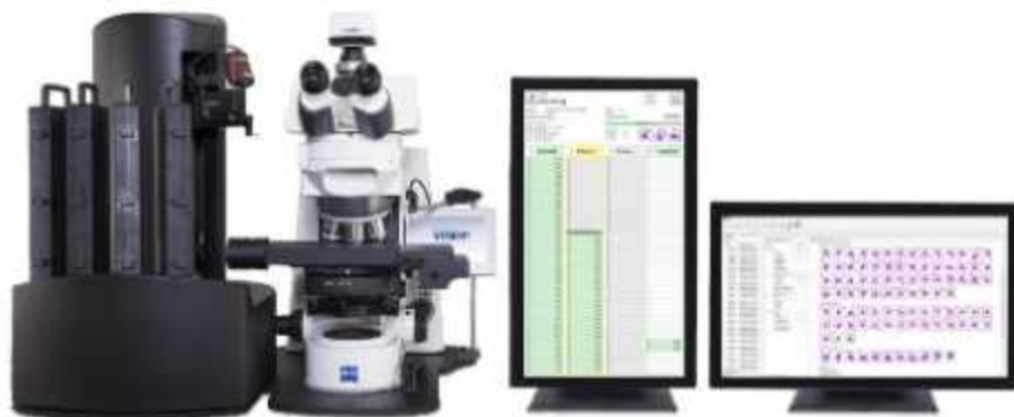
شکل ۱۸-۱: دستگاه الومایک برسی نام خون محیطی Vion Remo Ultimate که قادر است هر سل را در عرض ۱ دقیقه و ۲۰۰ تست در هر شیفت در حضور یک کارشناس اسکن و بررسی کند. این در حالی است که هر فرد قادر است فقط ۸۰ تست را در یک شیفت بررسی کند، لذا در یک روز دو جبهه (صبح و عصر) با ۲۰۰ تست کار به میکروسکوپ و ۹ کارشناس را با یک دستگاه الومایک و دو کارشناس انجام می‌دهد.
