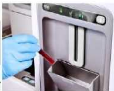
شکل ۱-۱۱: نحوه نمونه دهی با رک، دستی و STAT (۳ نمونه اورژانسی را می تواند دریافت کند) و نحوه بارگذاری لام های خام
