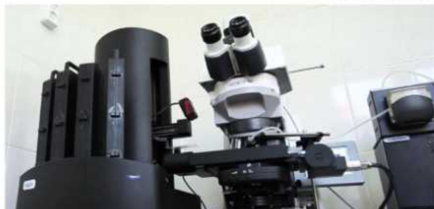
شکل ۱۸-۱: دستگاه الومایک برسی نام خون محیطی Vion Remo Ultimate که قادر است هر سل را در عرض ۱ دقیقه و ۲۰۰ تست در هر شیفت در حضور یک کارشناس اسکن و بررسی کند. این در حالی است که هر فرد قادر است فقط ۸۰ تست را در یک شیفت بررسی کند، لذا در یک روز دو جبهه (صبح و عصر) با ۲۰۰ تست کار به میکروسکوپ و ۹ کارشناس را با یک دستگاه الومایک و دو کارشناس انجام می‌دهد.
