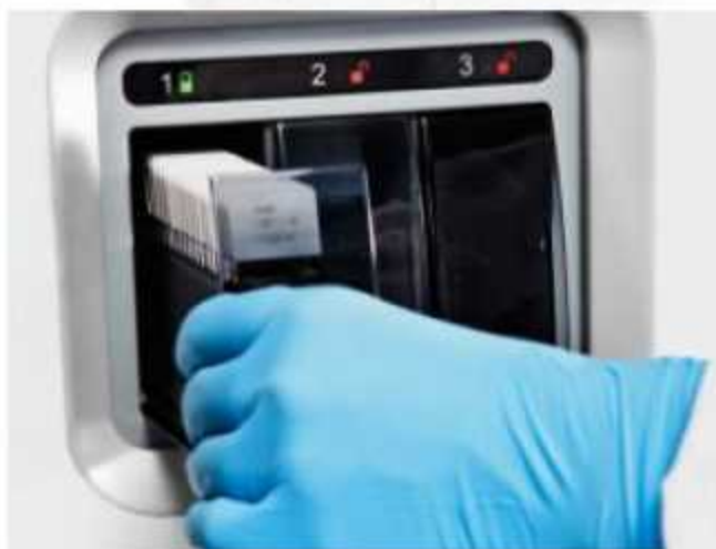
شکل ۱-۱۱: دستگاه کوباس M-511 که در دمای ۲۷-۱۸ درجه و رطوبت ۶۰-۲۰٪ عملکرد مطلوب تری دارد.
