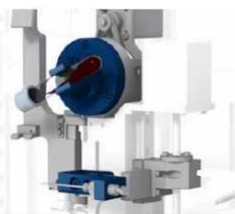
شکل ۱-۱۱: دستگاه نمونه ها را از رک برداشته و بعد از ۱۰ بار سر و ته کردن اقدام به ساکشن نمونه و پرینت آن بر روی لام می کند تا یک تک لایه از سلول ها حاصل شود.
