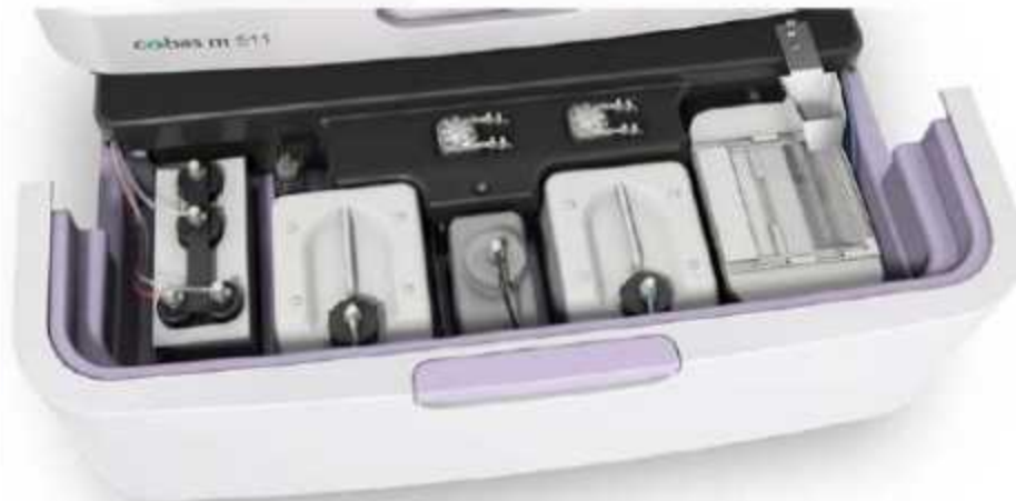
شکل ۱-۱۱: دستگاه کوباس M-511 که در دمای ۲۷-۱۸ درجه و رطوبت ۶۰-۲۰٪ عملکرد مطلوب تری دارد.
