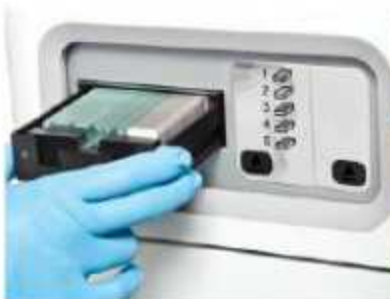
شکل ۱-۱۱: نحوه نمونه دهی با رک، دستی و STAT (۳ نمونه اورژانسی را می تواند دریافت کند) و نحوه بارگذاری لام های خام
