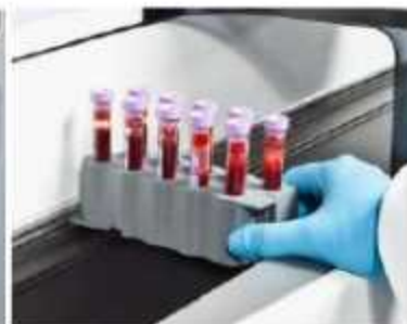
شکل ۱-۱۱: نحوه نمونه دهی با رک، دستی و STAT (۳ نمونه اورژانسی را می تواند دریافت کند) و نحوه بارگذاری لام های خام
