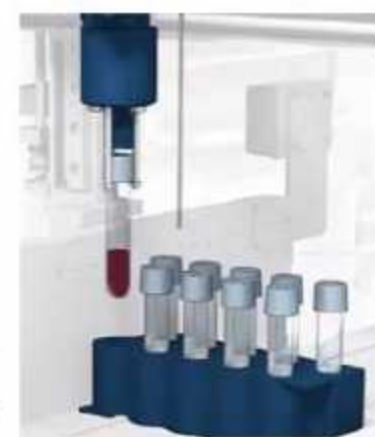
شکل ۱-۱۱: دستگاه نمونه ها را از رک برداشته و بعد از ۱۰ بار سر و ته کردن اقدام به ساکشن نمونه و پرینت آن بر روی لام می کند تا یک تک لایه از سلول ها حاصل شود.
