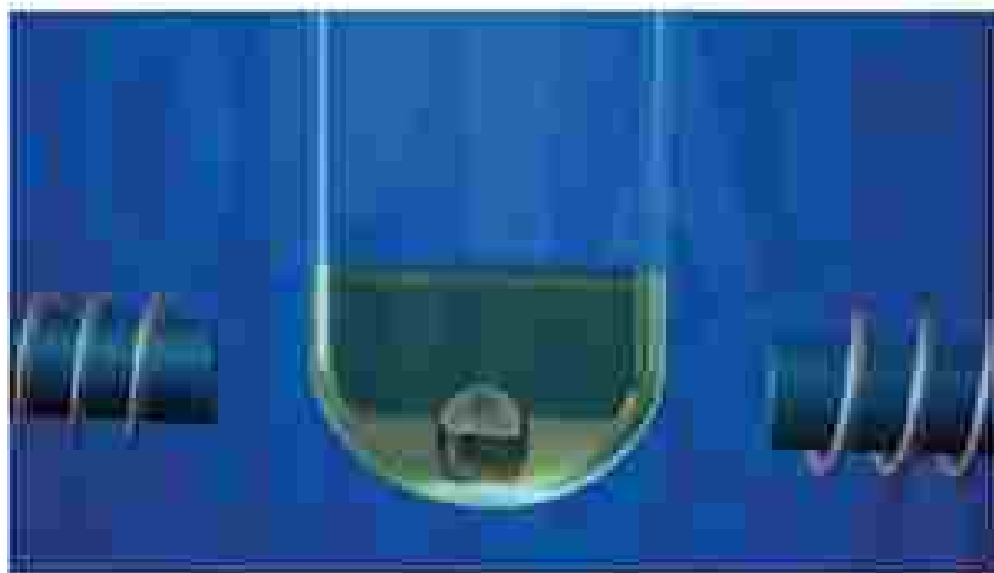
شکل ۶۸-۵۴: دستگاه‌های کوآگولومتر ساچمه‌ای که از توقف حرکت ساچمه در درون لخته فibrینی پی به لخته شدن پلازما می‌برند.
