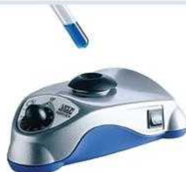
شکل ۱۵-۴۶: انواع ورتکس‌های آزمایشگاهی که باعث میکس شدید همولیزانت به روش دورانی می شود.
