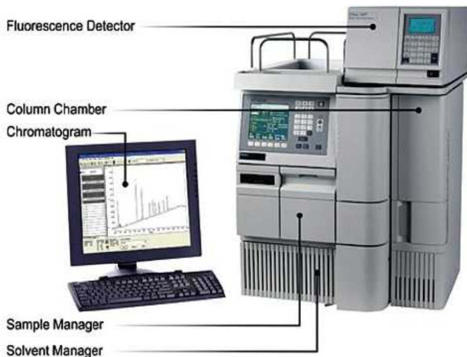
شکل ۴۵-۴۶: دو دستگاه پیشرفته HPLC جهت شناسایی و تشخیص انواع پروتئین‌ها، داروها و هموگلوبین‌های مختلف
