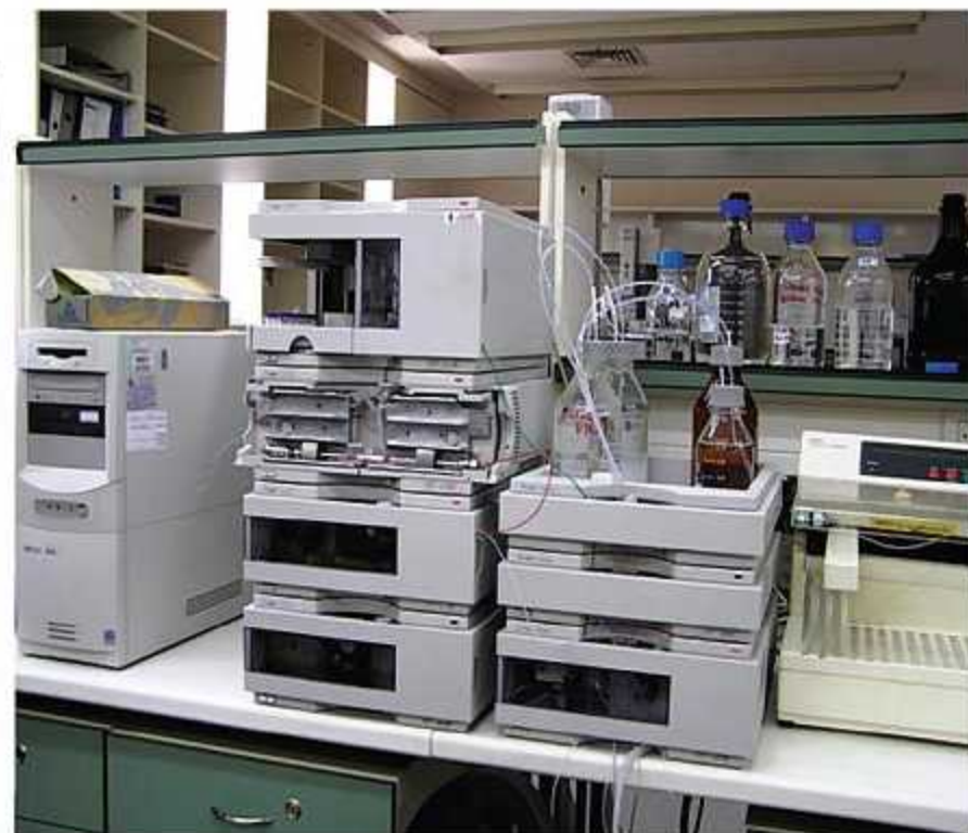
شکل ۴۵-۴۶: دو دستگاه پیشرفته HPLC جهت شناسایی و تشخیص انواع پروتئین‌ها، داروها و هموگلوبین‌های مختلف
