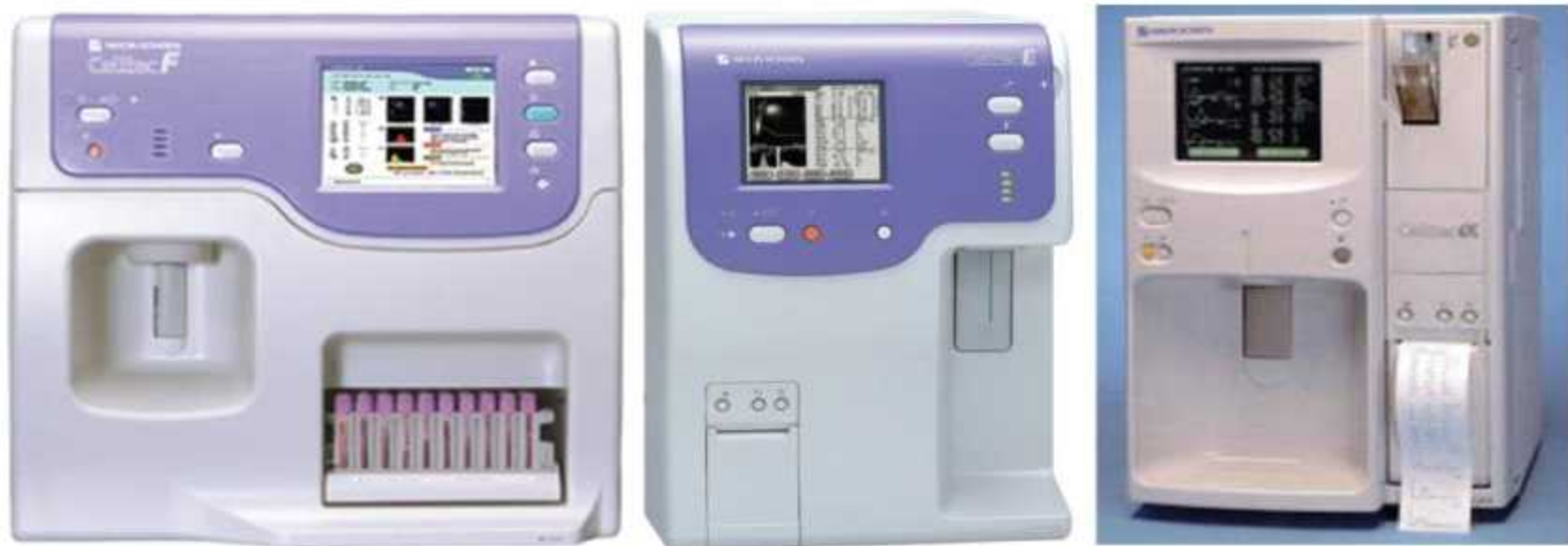
شکل ۶۹-۱۱: سل کانترهای Celltac سری \alpha ، E و F که در سری F ویال‌های CBC در داخل رک‌های بخصوصی قرار گرفته و نمونه برداری به صورت اتوماتیک انجام می‌شود (سیستم بسته). سری E و F بر خلاف سری \alpha از روش VOC استفاده می‌کنند.
