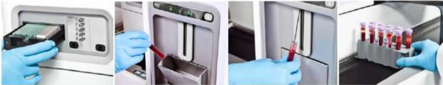
شکل ۱۱-۱: نحوه نمونه دهی با رک، دستی و STAT (۳ نمونه اورژانسی را می توان دریافت کند) و نحوه بارگذاری لام های خام
