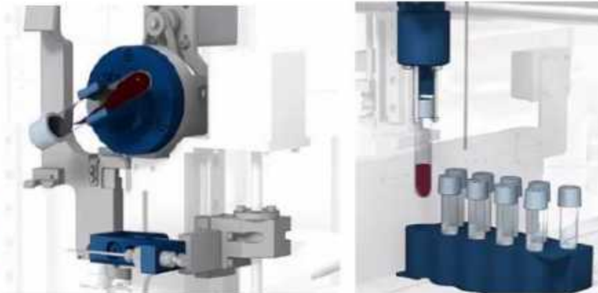
شکل ۱۱-۱: دستگاه نمونه ها را از رک برداشته و بعد از ۱۰ بار سر و ته کردن اقدام به ساکشن نمونه و پرینت آن بر روی لام می کند تا یک تک لایه از سلول ها حاصل شود.
