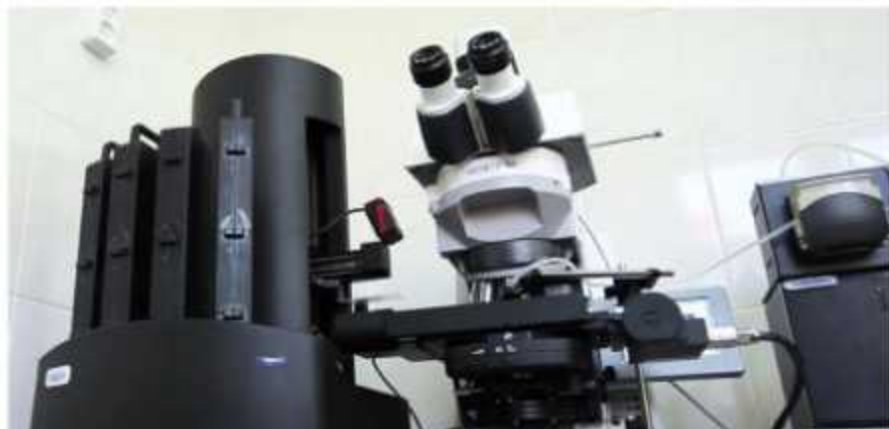
شکل ۱۸۰-۱: دستگاه اپتیک بررسی لام خون محیطی Vision Research Ultimate که قادر است هر لام را در عرض ۱ دقیقه و ۳۵۰ تست در هر شیفت در حضور یک کارشناس اسکن و بررسی کند. این در حالی است که هر فرد قادر است فقط ۸۰ تست را در یک شیفت بررسی کند، لذا در یک روز دو جعبه اصیج و عصر با ۲۰۰ تست کار به میکروسکوپ و ۹ کارشناس را با یک دستگاه اپتیک و دو کارشناس انجام می‌دهد.
