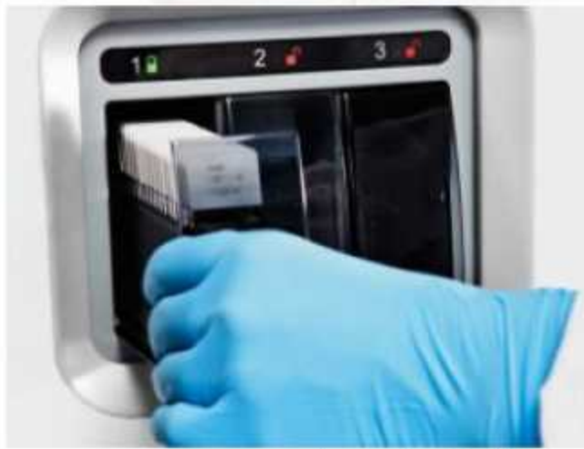
شکل ۱۱-۱: دستگاه کویاس M-511 که در دمای ۱۸-۲۷ درجه و رطوبت ۶۰-۲۰٪ عملکرد مطلوب تری دارد.
