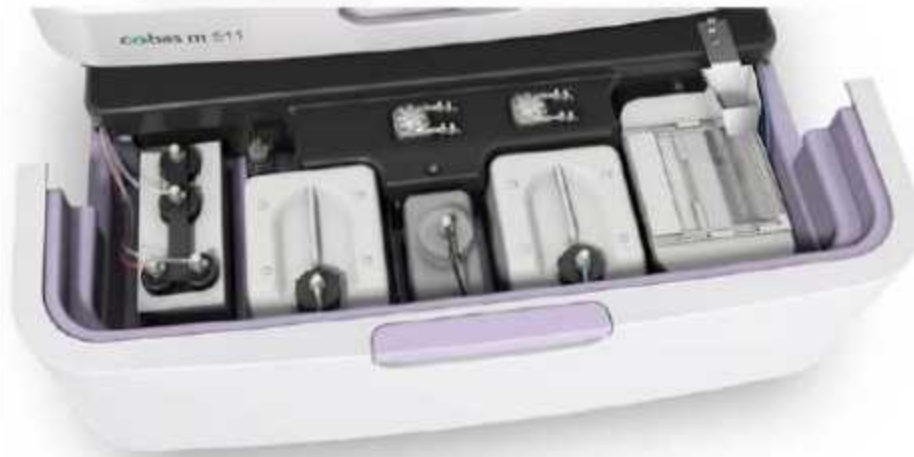
شکل ۱۱-۱: دستگاه کویاس M-511 که در دمای ۱۸-۲۷ درجه و رطوبت ۶۰-۲۰٪ عملکرد مطلوب تری دارد.
