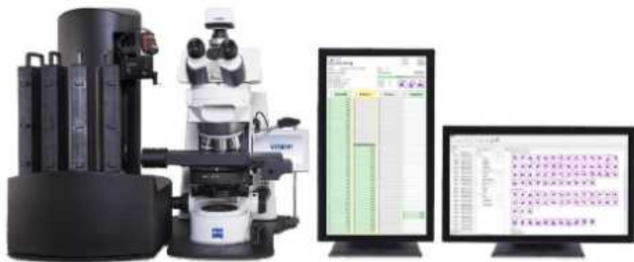
شکل ۱۸۰-۱: دستگاه اپتیک بررسی لام خون محیطی Vision Research Ultimate که قادر است هر لام را در عرض ۱ دقیقه و ۳۵۰ تست در هر شیفت در حضور یک کارشناس اسکن و بررسی کند. این در حالی است که هر فرد قادر است فقط ۸۰ تست را در یک شیفت بررسی کند، لذا در یک روز دو جعبه اصیج و عصر با ۲۰۰ تست کار به میکروسکوپ و ۹ کارشناس را با یک دستگاه اپتیک و دو کارشناس انجام می‌دهد.
